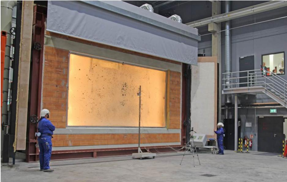
**Bild 5** Feuerwiderstandsprüfung Brandschutzglas (5900 mm x 3100 mm) im Brandschutzzentrum Rosenheim, das gemeinsam von ift Rosenheim und UL betrieben werden. Das Labor ist für die Prüfung großformatiger Bauteile wie Brand-/Rauchschutzelemente, Fassaden, Fenster, Flügel-/Schiebetore, Türen, Dach und Wandelemente nach europäischen, amerikanischen und weiteren internationalen Normen ausgelegt.
